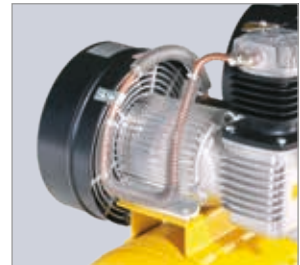
Direktgekoppeltes Aggregat Antriebsmotor direkt am Kompressorblock; robust und langlebig dank niedriger Drehzahl von nur 1500 U/min.
